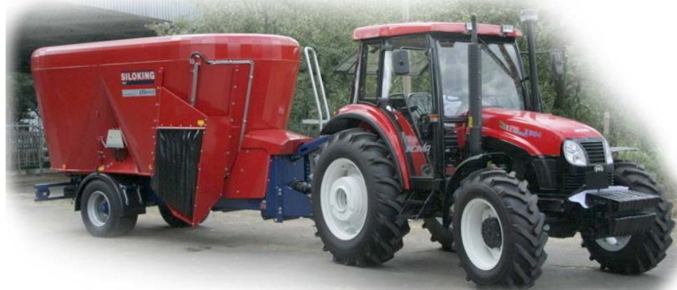
DUO 16 1814-16 ВG с трактором УТO Х904 90 л.с. Высота 2.85, ширина 2,33
