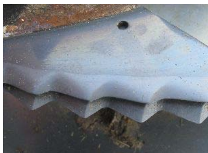
Износ ножей Siloking за 1 год
