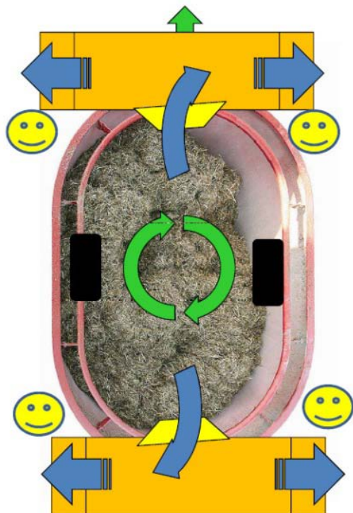
Выгрузка в невысокие кормушки (до 60 см) и на кормовой стол
