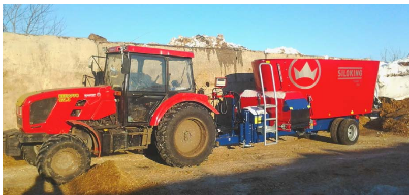
DUO 13 с трактором Беларус 921.3 Высота 2.42 м, ширина 2.06 м
