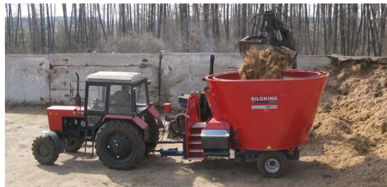
Premium 12 с трактором МТЗ 82.1 Высота 2.80, ширина 2,55
