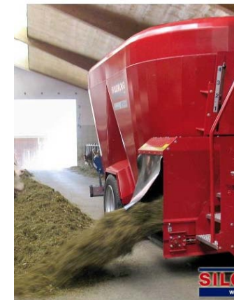
Выгрузка в невысокие кормушки (до 60 см) и на кормовой стол
